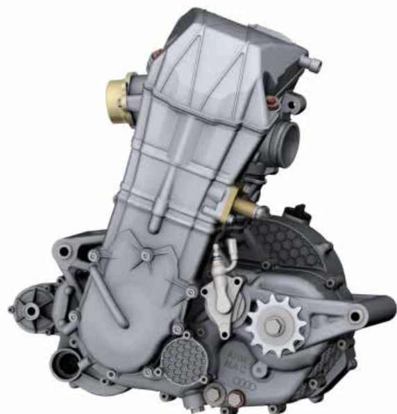
Der 3D gedruckte Motor. (Quelle: SLM Solutions)
