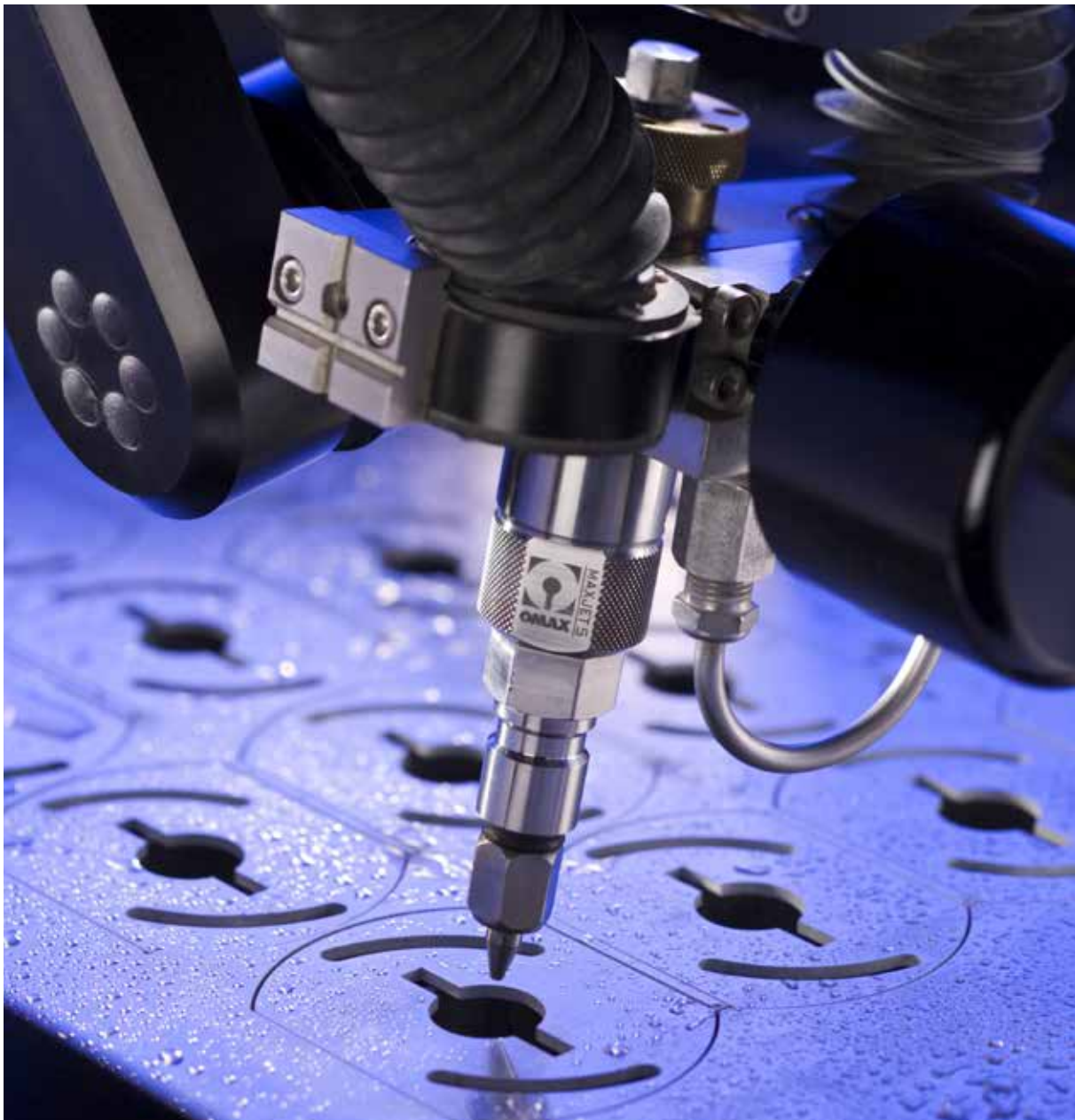
Der Tilt-A-Jet-Schneidkopf gleicht die Konizität des Wasserstrahlschnittes durch Datenbankgesteuerte Schrägstellung aus. (Quelle: INNOMAX AG)
