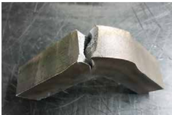
Abb. 2: Schadensfall autogener Brennschnitt. (Quelle: HWK-Koblenz)
