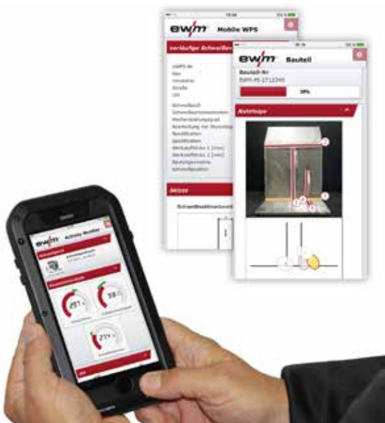
Alle Daten aus einer Hand: Per Smartphone oder Tablet kann beispielsweise die Schweißaufsichtsperson vor Ort am Schweißgerät alle aktuellen Parameter einsehen. (Quelle: EWM AG)
