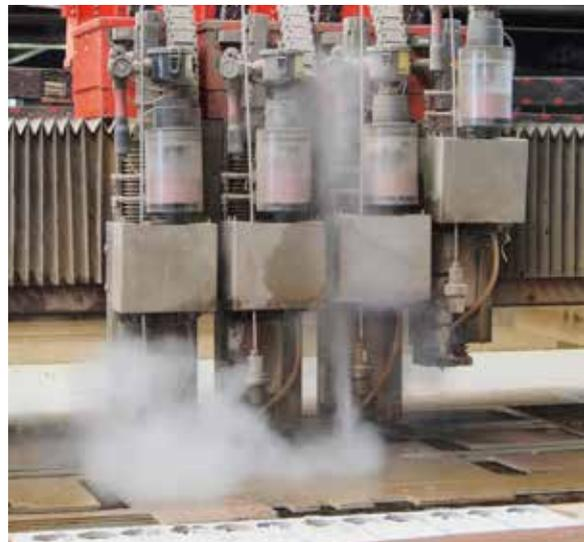
Wasserstrahlschneiden (Foto: Schneidforum)
