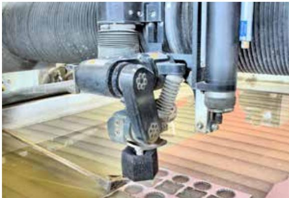
Der Präzisionsschneidkopf ›Tilt-A-Jet‹ ermöglicht es, absolut winklige Teile mit einer Genauigkeit von  $\pm 0,02$  Millimetern herzustellen. (Foto: INNOMAX AG)
