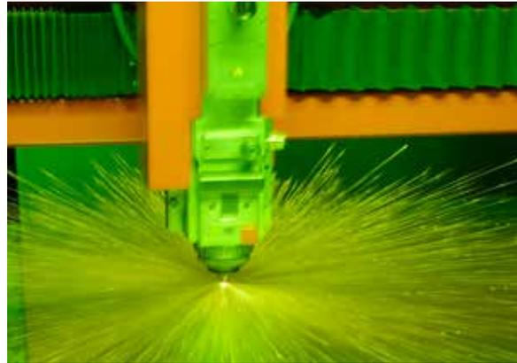
Laserstrahlschneiden (Foto: Schneidforum)
