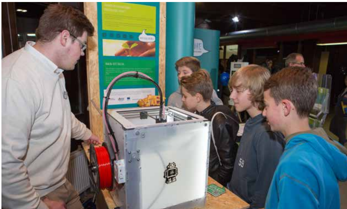
Auch auf der Koblenzer Nacht der Technik wurde der 3D-Druck thematisiert. HwK-Koblenz-Mitarbeiter Dennis Frank demonstriert das FDM-Verfahren (Fused Deposition Modeling), bei dem flüssiger Kunststoff durch eine feine Düse gepresst wird und so Schicht für Schicht das Bauteil aufbaut. (Foto: Klaus Herzmann)
