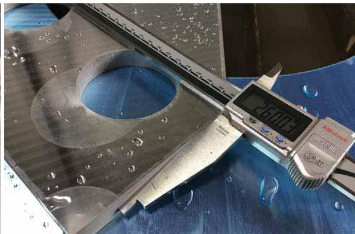
Maschinenbauteile werden bis 0,03 mm genau gefertigt – der OMAX Schwenkkopf kompensiert Winkelfehler automatisch (Quelle: INNOMAX AG)
