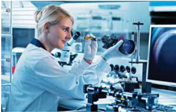
*Feinmechanische Justage an einer optoelektronischen Objektivbaugruppe. Das Arbeiten in sauberer Umgebung ist eine Voraussetzung für optimale Abbildungsqualität (Quelle: BERLINER GLAS)*
