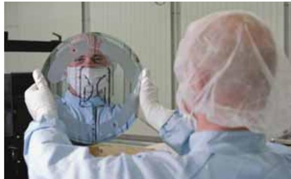
*Demonstrator eines „Waferchucks“ mit Berliner Glas Logo. Solche hochpräzisen Haltevorrichtungen für Siliziumwafer werden bei der Chipherstellung eingesetzt. Unebenheiten von unter einem Mikrometer und viele hundert Arbeitsschritte sind typisch für diese Produkte, welche die Wafer durch Vakuum oder Elektrostatik eben halten (Quelle: BERLINER GLAS)*
