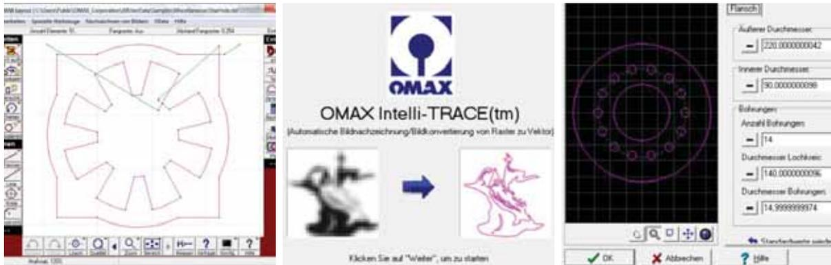
Die OMAX Software ermöglicht sehr schnell und einfach Schneidprogramme zu erstellen – selbst Fotos können als Schneidvorlage eingelesen werden und häufige Konturen wie Flansche, Zahnräder, Zugproben können schnell mit wenigen Daten erstellt werden – ohne Programmierung (Quelle: INNOMAX AG)
