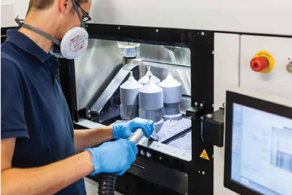
Absaugen des überschüssigen Metallpulvers im Bauraum einer SLM Fertigungsanlage (Quelle: LIGHTWAY GmbH & Co. KG)
