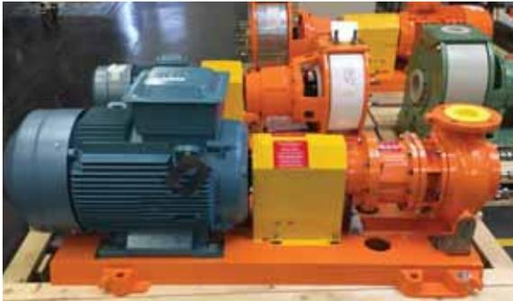
Exemplarische Pumpe: Der Motor ist blau, der Kuppelungsschutz gelb, Pumpe und Grundplatte sind orange. (Quelle: MUNSCH Chemie-Pumpen GmbH)
