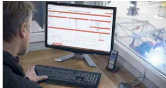
Der direkte Draht zum Schweißer: ewm Xnet vernetzt beliebig viele MIG/MAG- und WIG-Schweißgeräte mit beliebig vielen PCs per LAN/WLAN oder USB-Stick. (Quelle: EWM AG)
