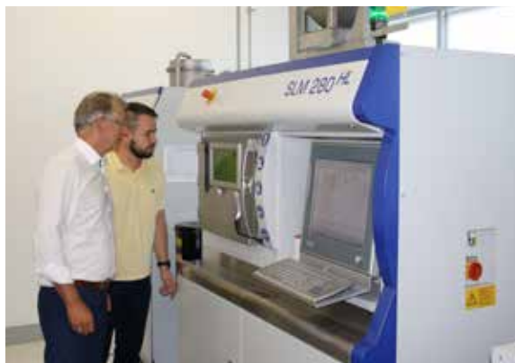
Mit der SLM®280 konnte SZEngine insgesamt neun Teile des Motors drucken. (Quelle: SLM Solutions)
