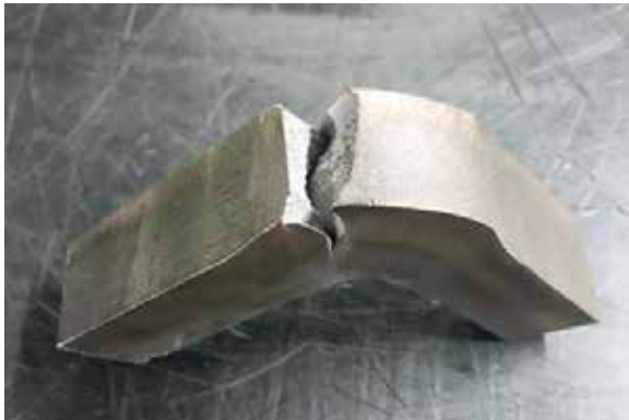
Abb. 2: Schadensfall autogener Brennschnitt. (Quelle: HWK-Koblenz)
