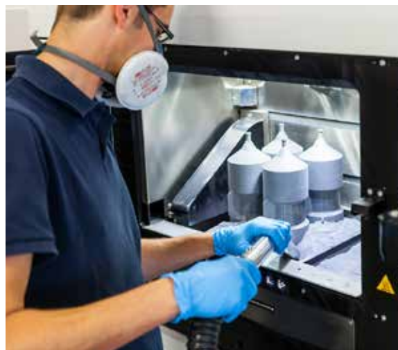
Absaugen des überschüssigen Metallpulvers im Bauraum einer SLM-Fertigungsanlage (Quelle: LIGHTWAY GmbH & Co. KG)
