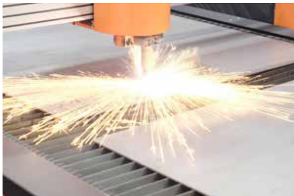
Anstechprozess beim Plasmastrahlschneiden zu Beginn einer neuen Kontur. (Quelle: Schneidforum Consulting)
