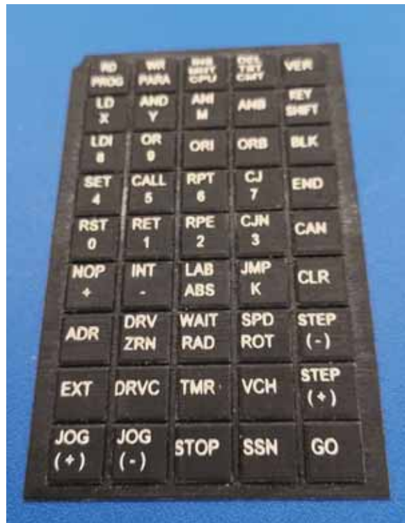
Abb. 4. b: Tastatureinlagen für Maschinensteuerungen (Foto: Ernst-Abbe-Hochschule Jena)
