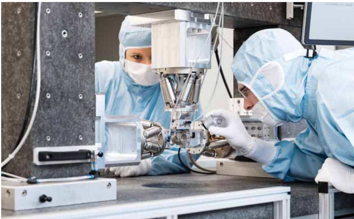
Präzisionsausrichtung von Linsen mit dem bei Berliner Glas entwickelten Alignmenttool. Mit der Vorrichtung können beliebige Elemente in sechs Freiheitsgraden auf 200 Nanometer genau zueinander ausgerichtet werden. Das Portal ist luftgelagert und frei auf dem Tisch positionierbar. (Foto: Berliner Glas KGaA)
