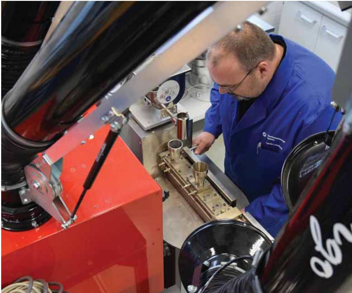
Der Wissens- und Technologietransfer zwischen Wissenschaft und Wirtschaft im Bereich der Kunststoffentwicklung und -bearbeitung ist Kernaufgabe des neu gegründeten Kunststoff-Technologie-Institut Koblenz (KTI Koblenz), im Bild eine Anlage, die verschiedene Kunststoffe thermisch in einem Materialträger zur anschließenden Erprobung vereint. (Foto: HwK Koblenz)
