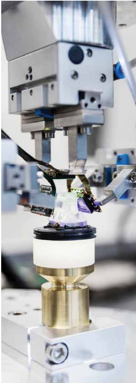
Simultanes Ausrichten von drei Bildsensoren einer RGB - Endoskopkamera. Die Bildsensoren können mit Genauigkeiten besser als ein halbes Pixel zueinander auf dem Phillips-Prisma montiert werden. (Foto: Berliner Glas KGaA)
