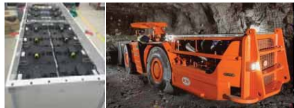
Pouch cells: 10 kWh Energieinhalt, 44 V Nennspannung, 100 kg Masse, integrierte Kühlung (Fotos: LMB Automation GmbH)
