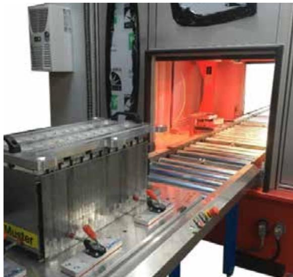
Bild 4: Rollenband mit Aufnahme und Batterie.
