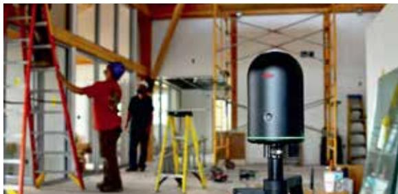
*3D-Scanner erfassen hochpräzise die Geometrie von Räumen und stellen die Daten ohne Medienbruch zur digitalen Weiterverarbeitung bereit. (Foto: Leica)*
