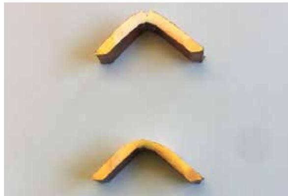
Ergebnisse der Biegeversuche der Schweißproben. (Foto: DSI Laser-Service GmbH)
