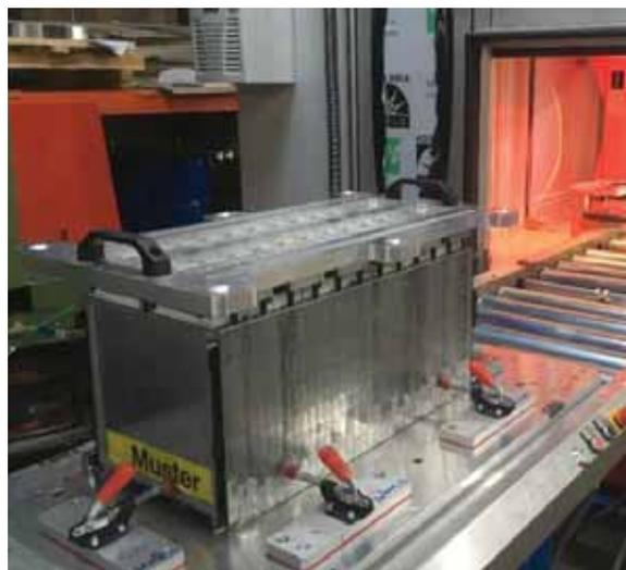
*Bei der Herstellung von Batterien sind an den Elektroden die Verbindungen zwischen den Batteriezellen zu schweißen, um höhere Leistungen zu erreichen. Der große Vorteil beim Laserschweißen liegt vor allem im präzisen und kurzen Energieeintrag, sodass die Erwärmung des umliegenden Materials wesentlich reduziert wird. (Foto: LMB Automation GmbH)*
