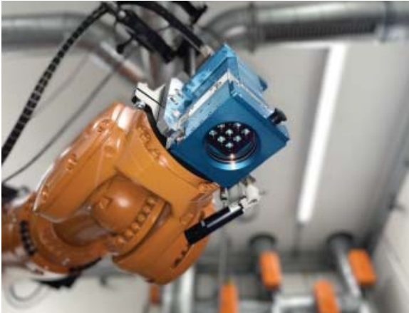
Mit der am Roboter montierten Multispot-Optik können 3D-Konturen abgefahren werden. (Foto: LZH)
