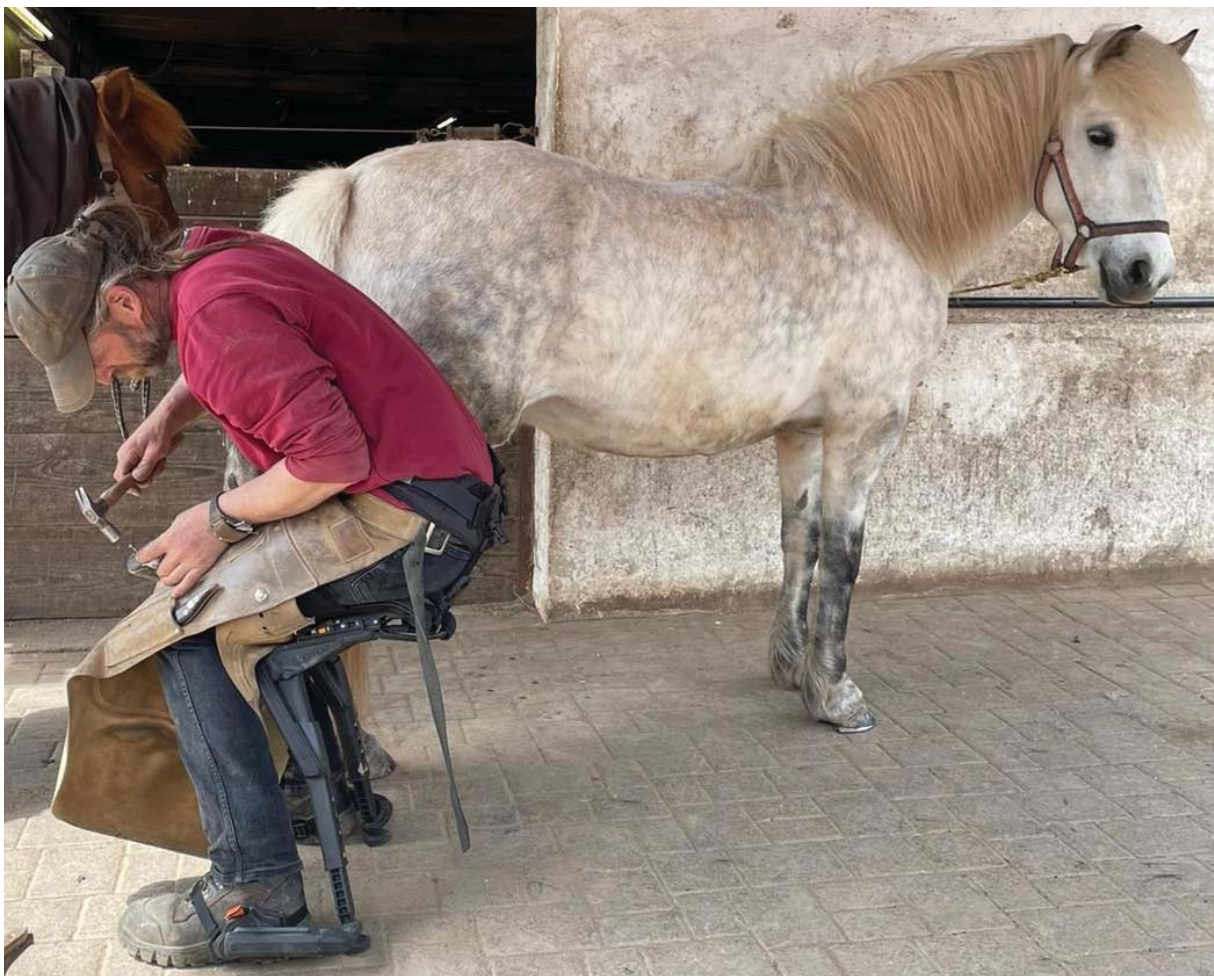
Bei wechselnden Steharbeitsplätzen oder Tätigkeiten im Hocken kann der ChairlessChair von Noonee Rücken und Beine entlasten (Foto: Noonee Germany GmbH)
