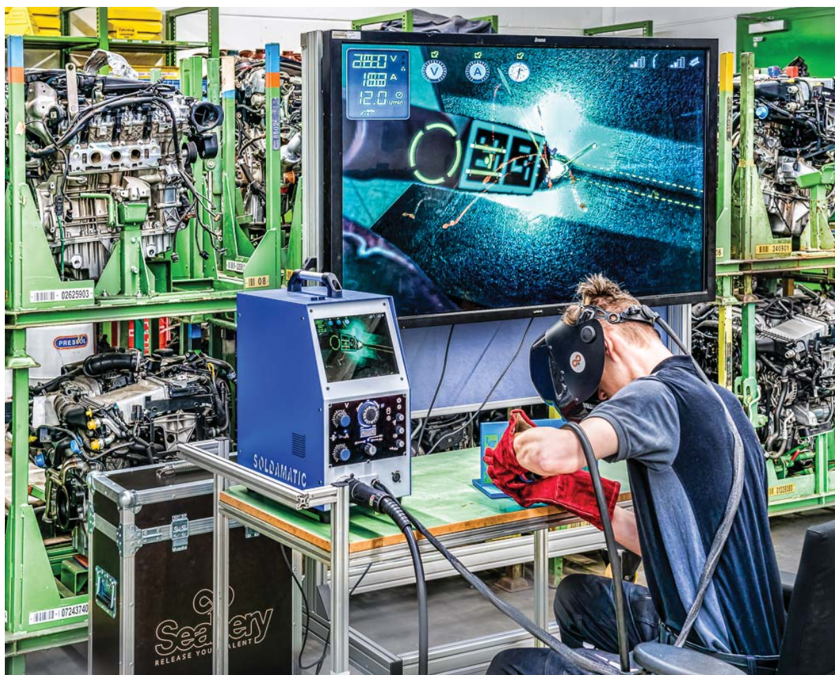
Virtuelle Trainingssysteme dienen zum ressourcenschonenden Erlernen von Handfertigkeiten beim Schweißen. (Foto: WeldPlus GmbH)
