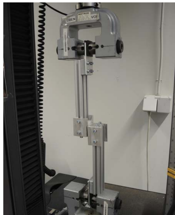
Scherprüfung einer 3D-Druck-Probe (Foto: TU Braunschweig)
