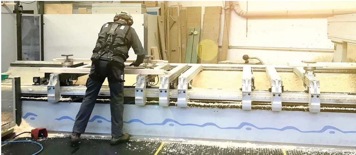
Das Bionic-Back von hTrius fällt wie viele Exoskelette im Arbeitsalltag kaum auf, entlastet den Rücken aber bei vielerlei Tätigkeiten (Foto: hTrius GmbH)
