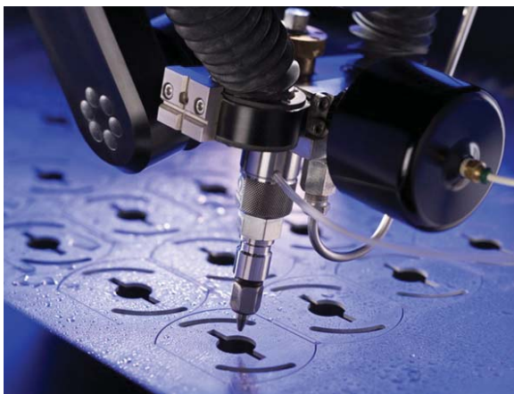
Wasserstrahlschneiden mit Schwenkkopf (Foto: INNOMAX)
