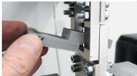
Abbildung 2b: Einlegen der Druckscherprobe. (Foto: TU Braunschweig)
