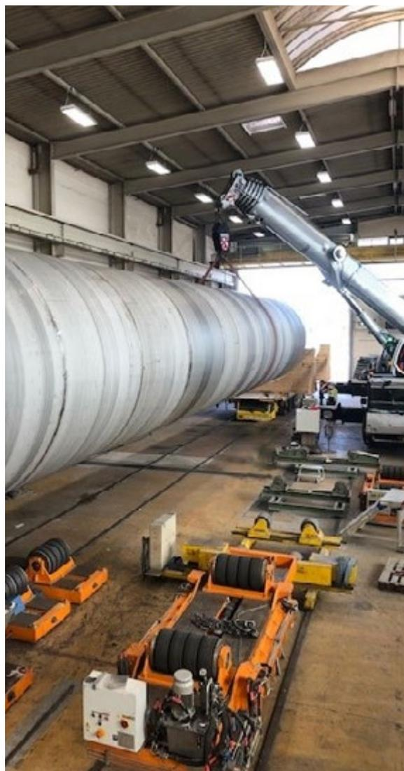
*Das Schweißen von Wasserstofftanks stellt hohe technologisch-mechanische Anforderungen an das eingesetzte Schweißverfahren, die forceTig® auch bei Tiefsttemperaturen komplett erfüllt. (Foto: EWM GmbH)*
