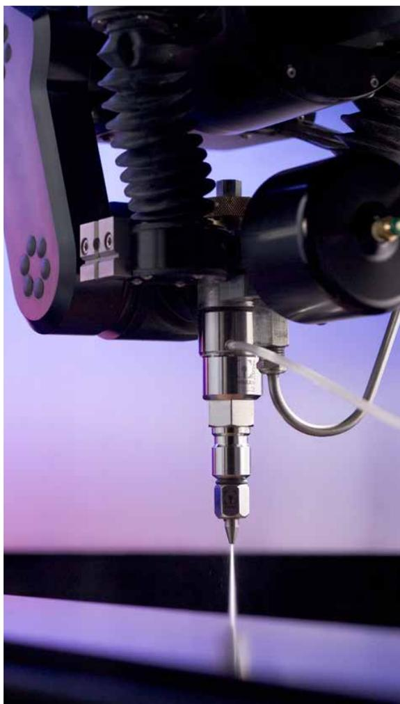
Der OMAX Tilt-A-Jet Präzisionsschneidkopf sorgt für rechtwinklige Schnitte und gleicht den natürlichen Schneidkegel effektiv aus. Er erreicht eine Genauigkeit von bis zu 20 µm. (Foto: INNOMAX AG)
