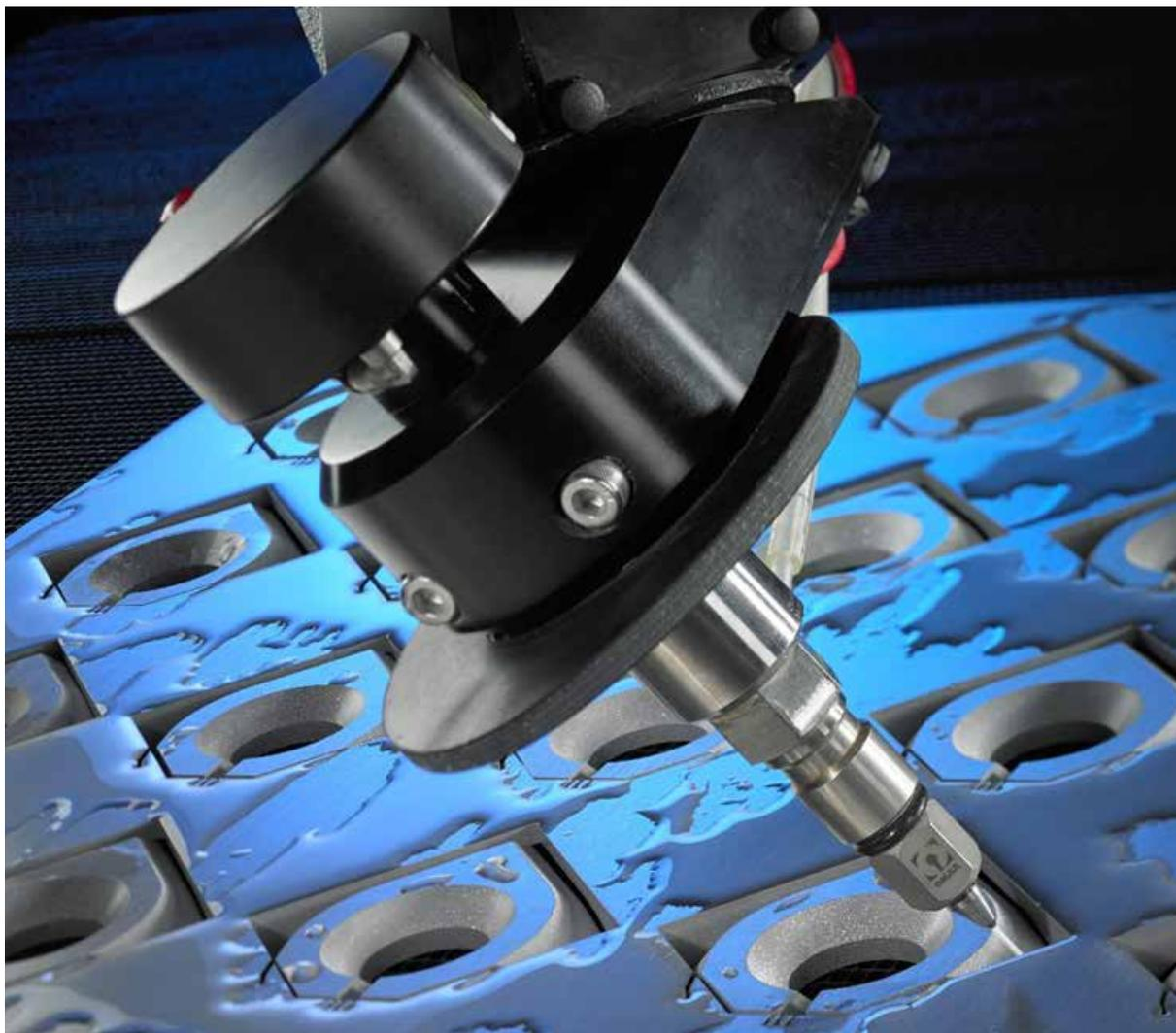
Mit dem komplett softwaregesteuerten OMAX A-Jet Winkelschneidkopf sind Schnittwinkel von bis zu 60 Grad möglich. (Foto: INNOMAX AG)
