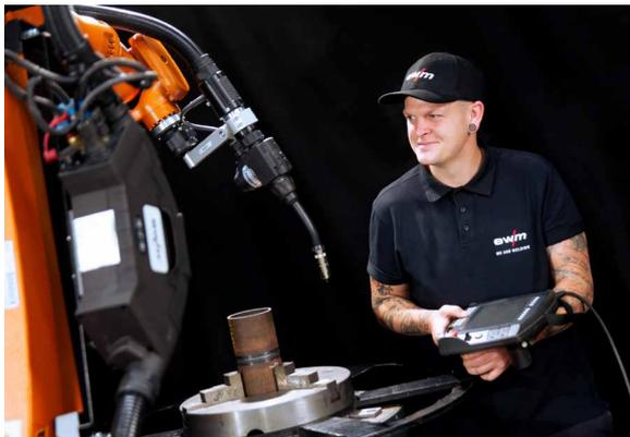
*EWM React bietet maximale Kontrolle und Prozesssicherheit beim automatisierten MIG/MAG-Schweißen. (Foto: EWM GmbH)*
