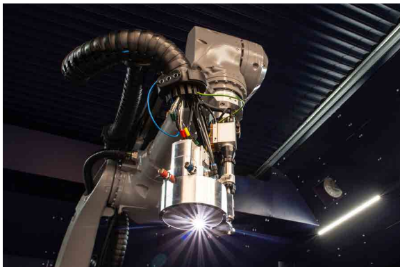
Die WAAM-Technologie nutzt den Schweißlichtbogen als Energiequelle, um einen Metalldraht zu schmelzen. (Foto: EWM GmbH)
