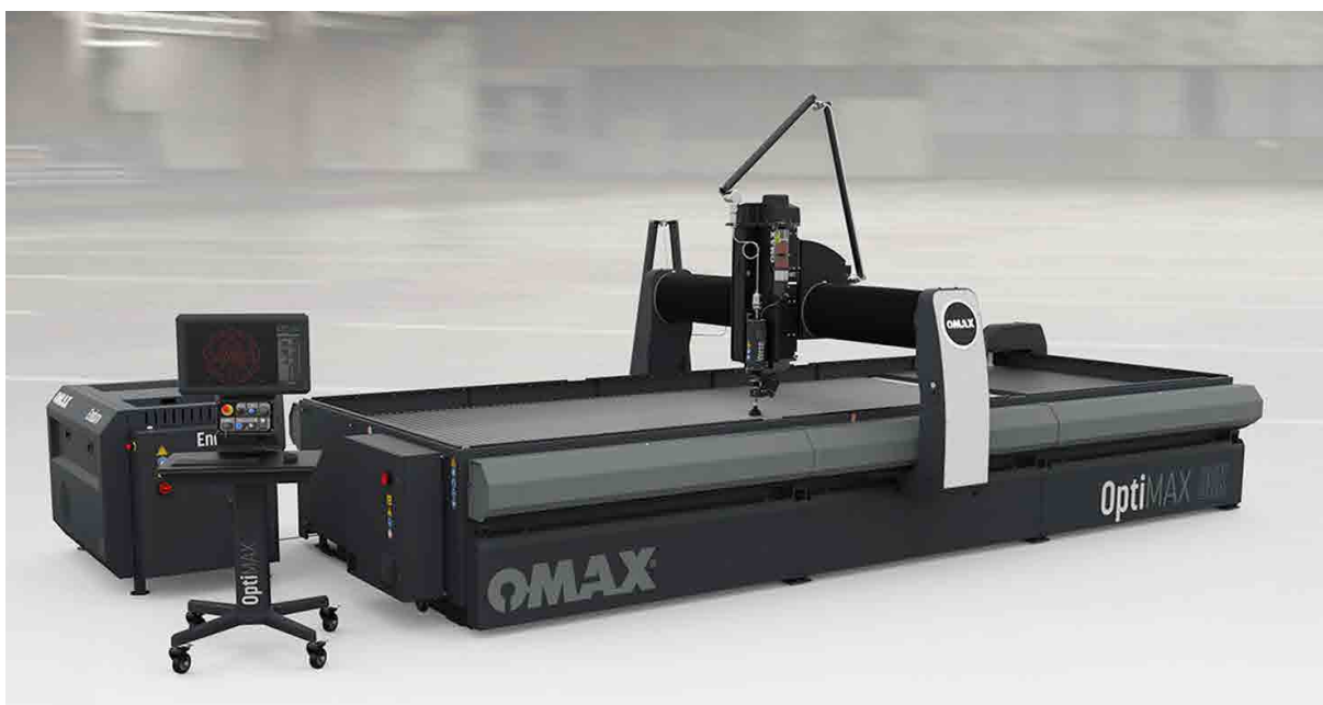
Brückensysteme sind in der Regel die Lösung für das Schneiden großformatiger Plattenmaterialien. Neben der größeren Materialaufnahme- und -abgabefläche sind diese Systeme aber oft auch unabdingbare Voraussetzung für die Ausrüstung mit mehreren Schneidköpfen und die Bestückung mit Winkelschneidköpfen. Der Abgebildete OMAX OptiMAX 80x hat eine Tischgröße von 6.578 mm x 3.937 mm. (Foto: INNOMAX AG)
