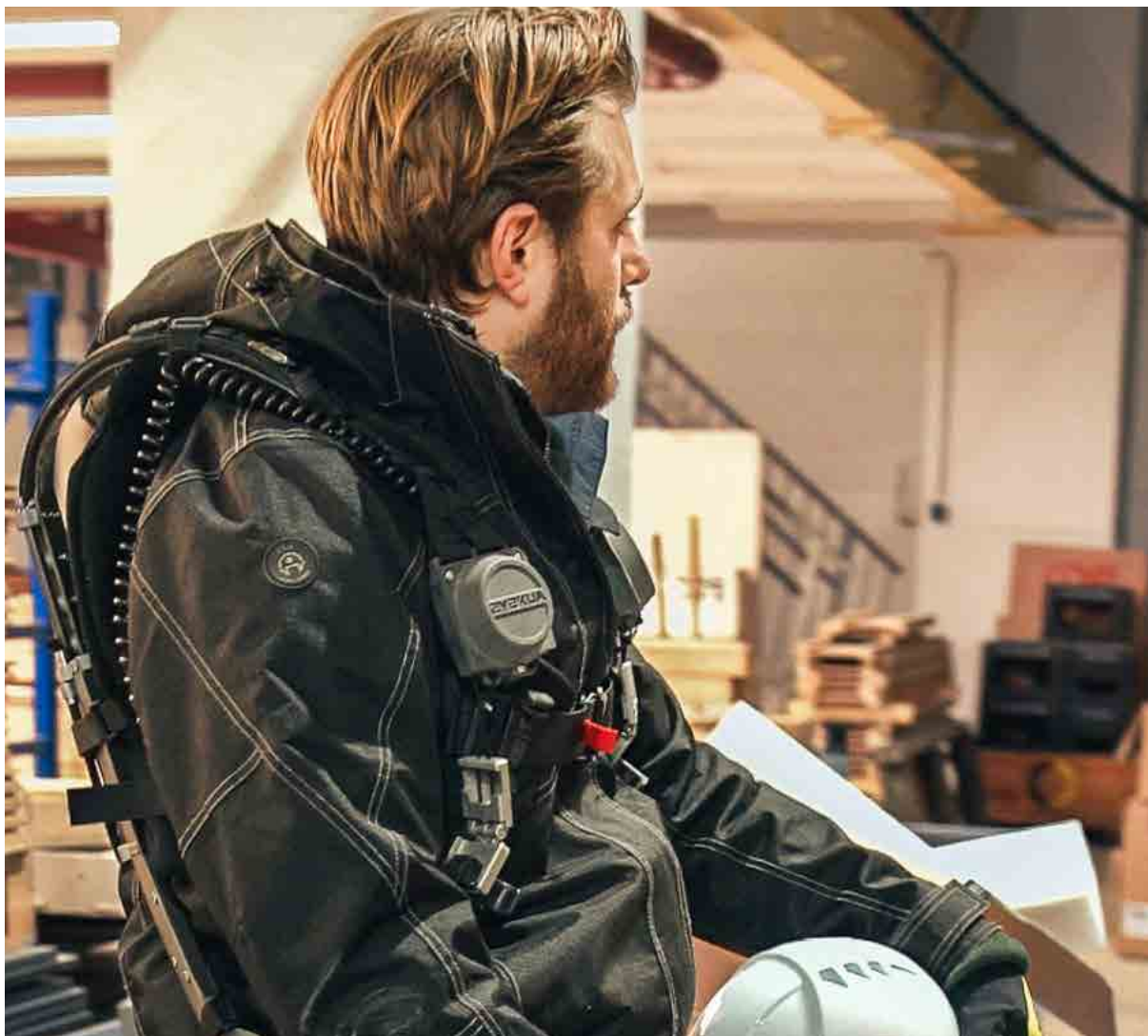
Exoskelett im Handwerk als Unterstützungssystem für körperlich belastende Tätigkeiten (Quelle: Projekt ReHopE)
