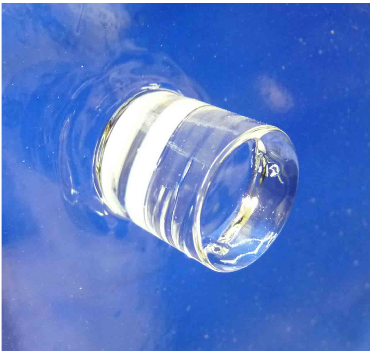
Abbildung 5: Eingeschweißter Haltbolzen in Laborgefäß aus Quarzglas (Foto: ifw Jena)
