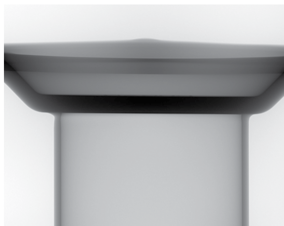
Abbildung 4: 2D-Röntgenaufnahme (versuchsbegleitende Probenbewertung, sehr gute Ausbildung der Kehlnaht durch Laserschweißen, Labormessgefäße 500 ml aus Borosilikatglas) (Foto: ifw Jena)
