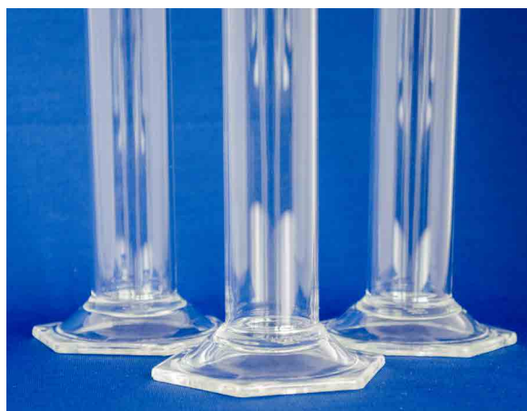
Abbildung 3: Lasergeschweißte Labormessgefäße aus Borosilikatglas (Foto: ifw Jena)
