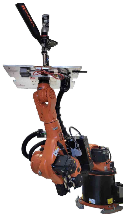
Laboraufbau aus Roboter und Granulatextruder mit bewegter Bauplattform und feststehendem Extruder (Foto: Ernst-Abbe-Hochschule Jena)
